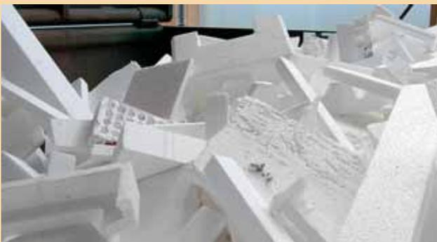
**Styropor gibt es in vielen Variationen und Farben. Aus produktionstechnischen Gründen kann die Recyclingfirma nur das weiße Styropor mit „kugelig“ Struktur wiederverwerten.** Das Styropor wird zerkleinert und in der Bauindustrie wieder als Dämmputz oder Dämmestrich eingesetzt.
